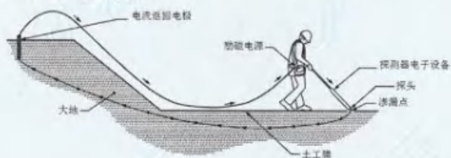
图 5.2 电火花法探测原理示意图
