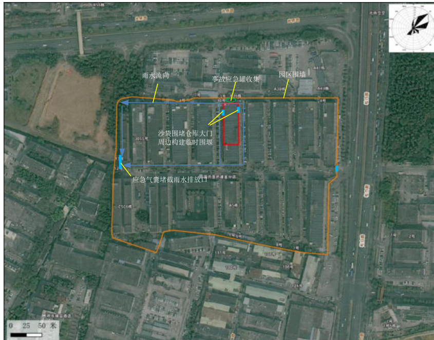
图7-1 项目事故废水封堵示意图
