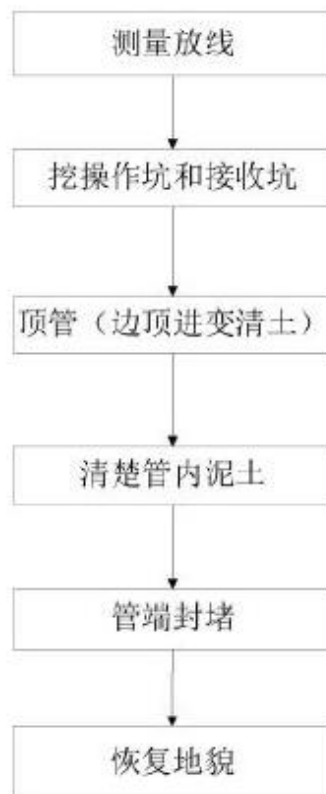
图 2.4-3 顶管施工工艺流程与产污环节图
