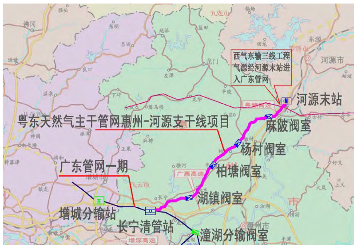
图 3.1-1 粤东天然气主干管网惠州-河源支干线工程线路图（环评阶段）
