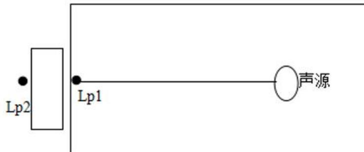
图 4-2 室内声源等效为室外声源图例
