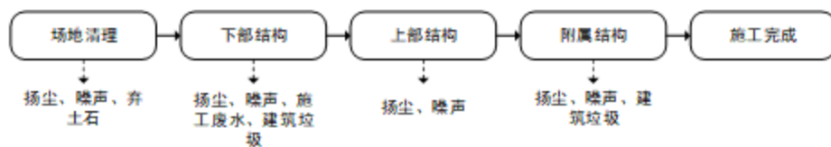
图 2-19 桥梁工程施工工艺及产污环节图
